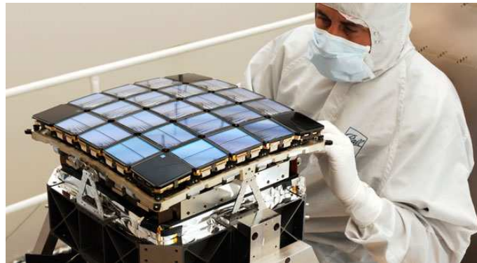
6. ábra. A Kepler űrtávcső CCD-chipjei. A kép forrása: [25]
